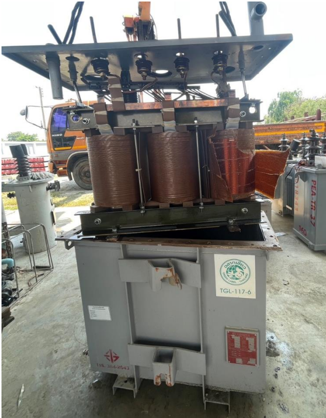
หม้อแปลง 3 เฟส PEA TR 64-017129 ขนาด 50 KVA
