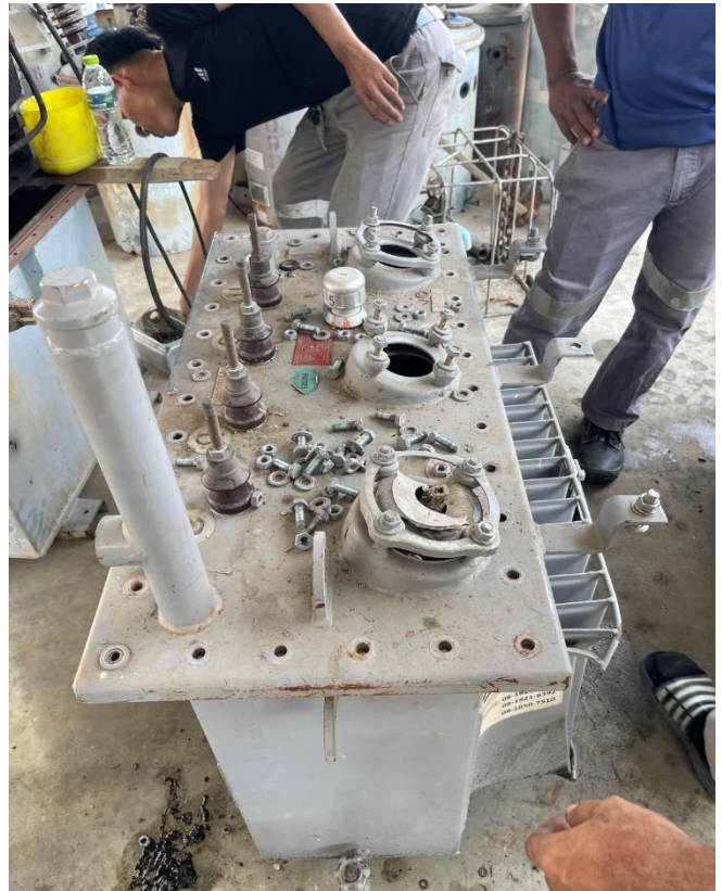
หม้อแปลง 3 เฟส PEA TR 64-017129 ขนาด 50 KVA
