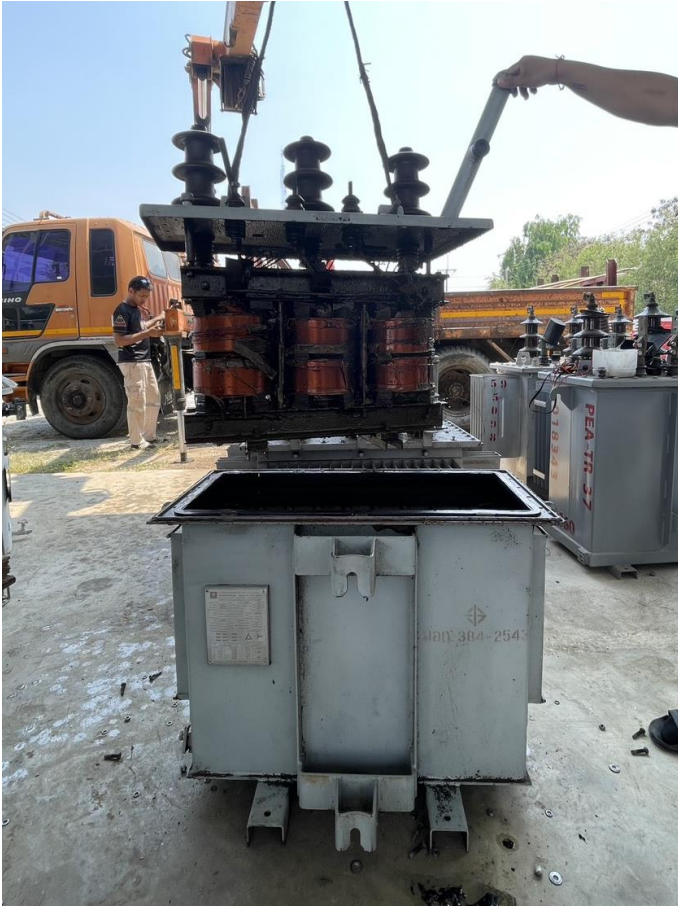
หม้อแปลง 3 เฟส PEA TR 50-002958 ขนาด 50 KVA
