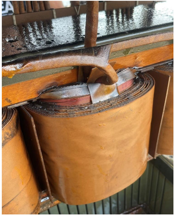
หม้อแปลง 3 เฟส PEA TR56-002092 ขนาด 160 KVA
