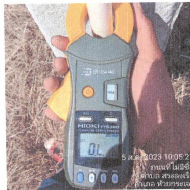
ภาพถ่ายค่าความต้านทานดิน
